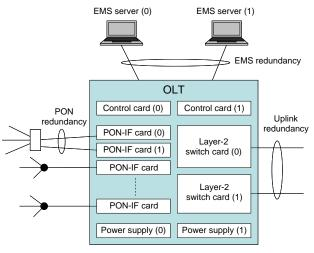
Fig. 2 Redundant structure
