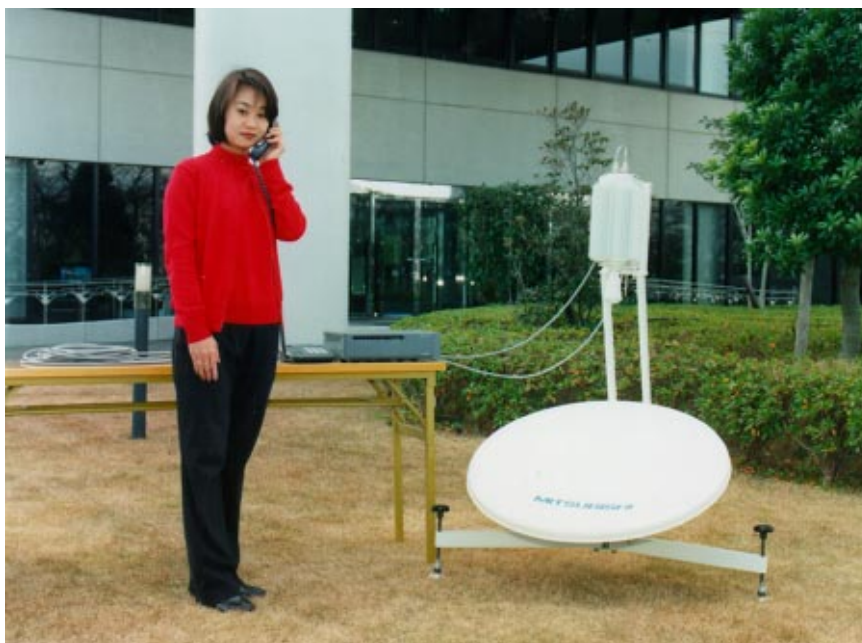
Fig. 1 The complete VSAT terminal.
